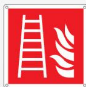
Scala antincendio F003
